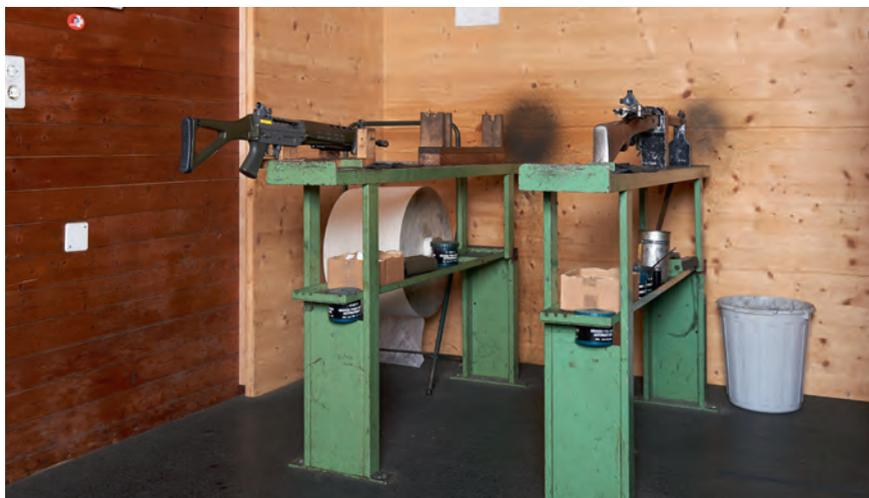
Illustration 18: Table de nettoyage fixée au sol d'une installation de tir
